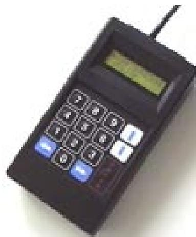
Per effettuare la programmazione dei parametri occorre utilizzare il **Programming Box** del sistema **MicroKey**. In questa fase si decidono i prezzi dei servizi da applicare ai livelli di utenza, i valori di monete e banconote, le opzioni del sistema (se abilitare la ricarica di chiavi elettroniche, le caratteristiche dei periodi Happy Hour, la distribuzione di servizi gratuiti ecc.)
