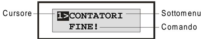
In questa figura si possono distinguere tutti i tratti caratteristici dei menu del **Programming Box**; vengono visualizzati due elementi del menu alla volta ed uno di questi è preceduto da un cursore in negativo. Il **cursore** contiene una freccia che seleziona una delle due voci ed un numero che indica il livello del menu visualizzato, ovvero a che distanza ci si trova dal Menu principale o Livello 1.
